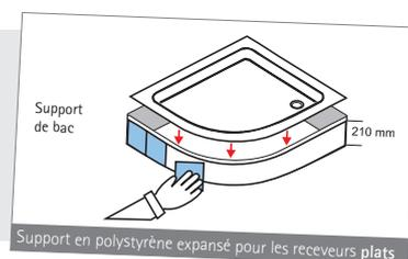
Support en polystyrène expansé pour les receveurs plats
