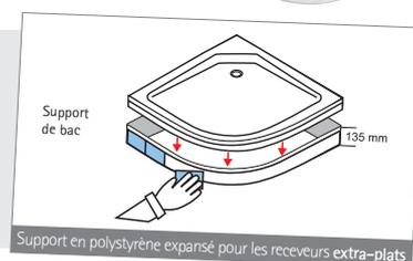
Support en polystyrène expansé pour les receveurs extra-plats
